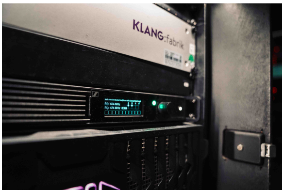
Prête à l'emploi en un instant : la station de base Spectera 19", 1U (au centre).
